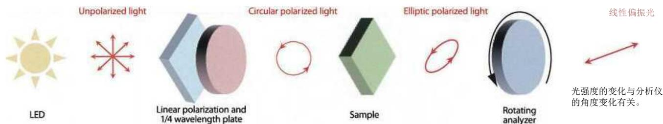
当圆偏振光进入内部有应变的被测物体时，受双折射的影响，偏振状态变为椭圆偏振。之后，仅平行于偏振器透射轴方向的光的分量通过旋转偏振光方法通过椭圆偏振光。在这种情况下，通过旋转分析仪的光的强度根据椭圆的状态显示出特定的变化。
